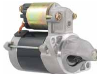
246-06107 STR. Denso 12V 0.6kW 9T CW DD
